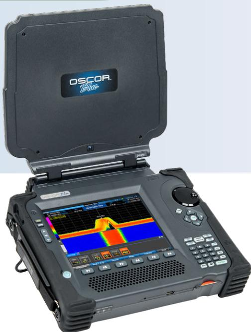
Completo analizador de espectro integrado con antenas incorporadas y software de análisis
