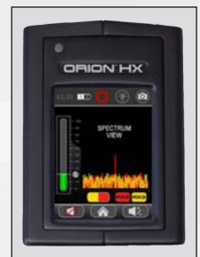
La vista del espectro muestra los gráficos del espectro de los 2º y 3º armónicos en varias opciones de vista
