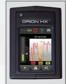
El gráfico del histograma muestra el historial de la respuesta armónica y el ajuste de la potencia de 10 a 60 segundos de duración.
