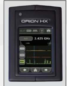
La pantalla de ajuste de la frecuencia muestra el 2do. y 3er. rango de frecuencia de transmisión.
