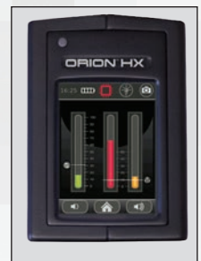
El gráfico de Tx y Rx muestra los niveles de potencia, 2º y 3º armónicos y los ajustes de nivel de potencia y disparo en la pantalla táctil.
