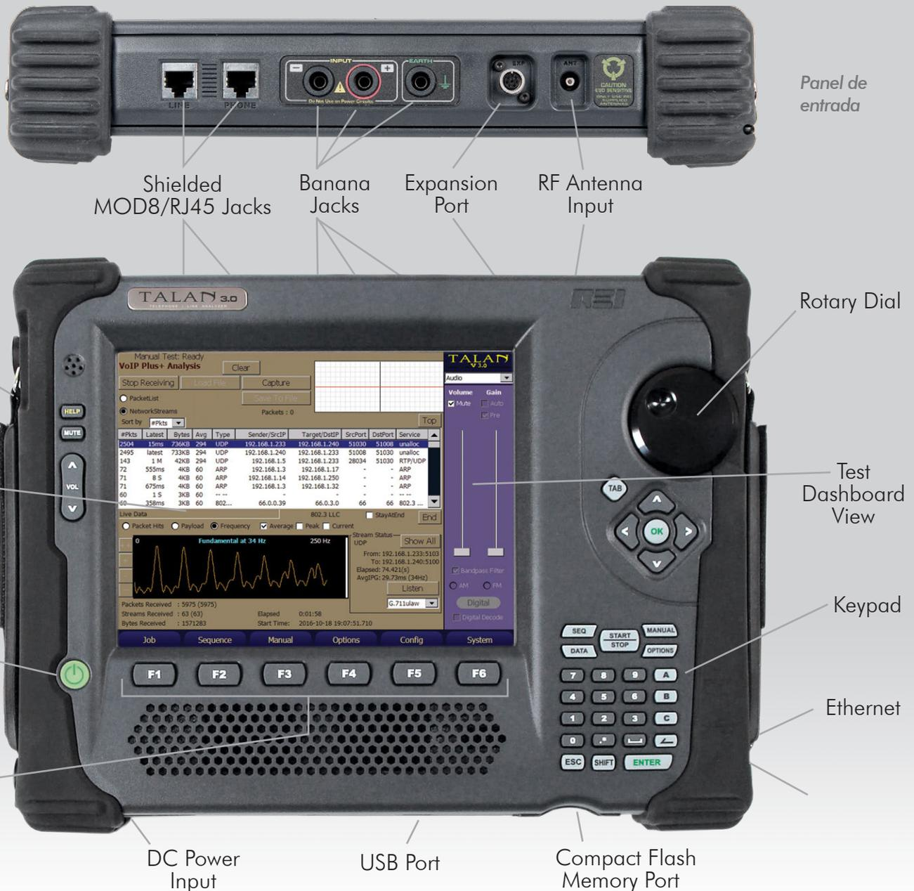
El TALAN proporciona un conjunto de herramientas en un solo equipo para analizar con precisión los teléfonos y las líneas en busca de fallos y violaciones de seguridad.
